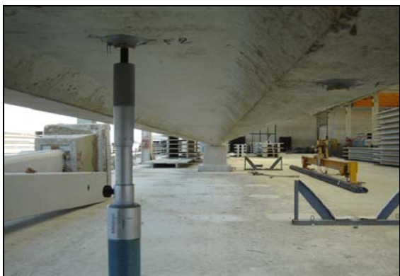
Figura 4: Particolare della testina micrometrica nella misura degli abbassamenti
