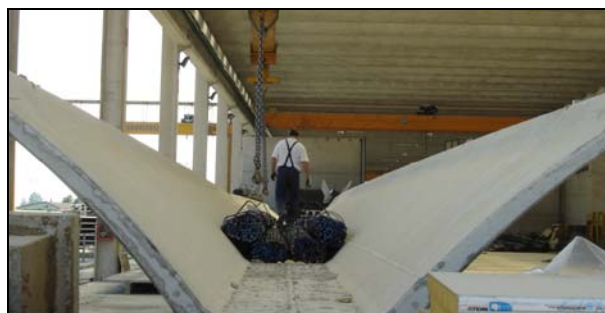
Figura 14: Vista del carico tegolo A
